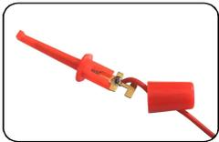
Припаяйте провод соответствующего цвета к клемме щупа, как показано на рисунке.
