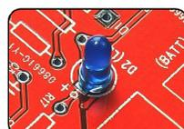
D2 : Светодиод, синий,  $\varnothing$  3 мм
