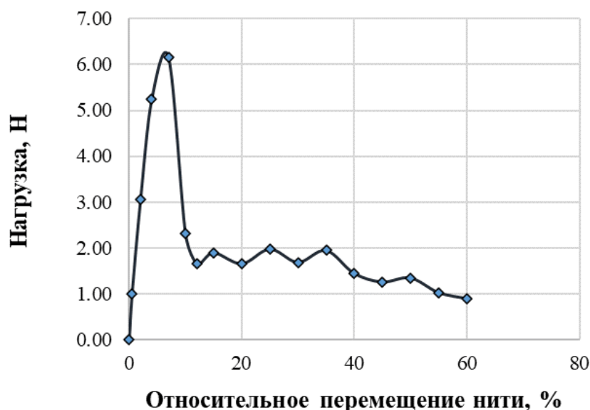
Рисунок 6 – Кривая зависимости «нагрузка – относительное перемещение» при вытягивании нити из образца
