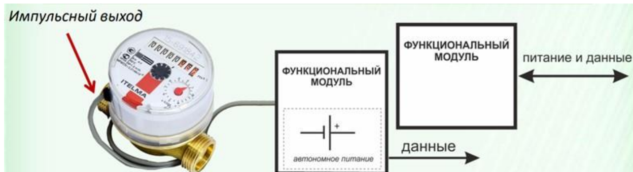
Рисунок 8 – Схема интеграции счётчика расхода воды в систему «умного» дома с помощью устройства с импульсивным выходом
