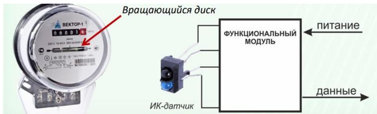
Рисунок 7 – Схема интеграции аналогового электросчётчика в систему «умного»
