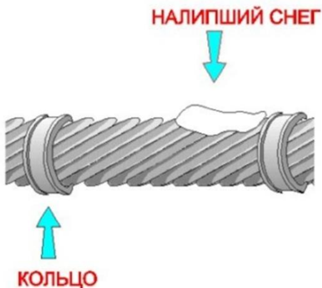
Рисунок 3 – Защитные кольца от налипания мокрого снега
