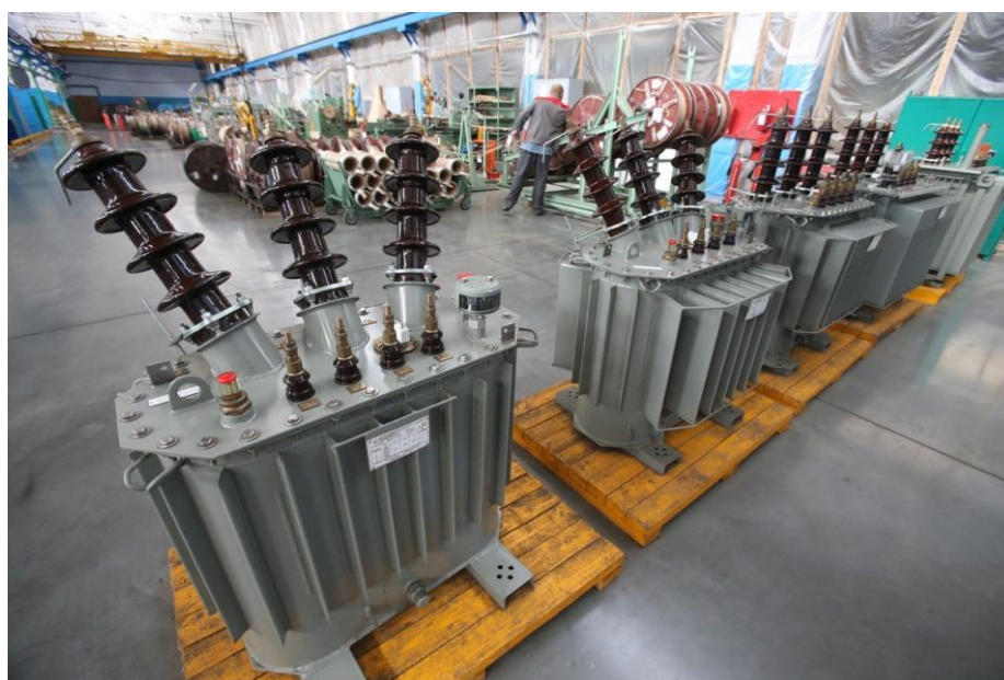
Рисунок 1 – Сборка энергоэффективных трансформаторов
