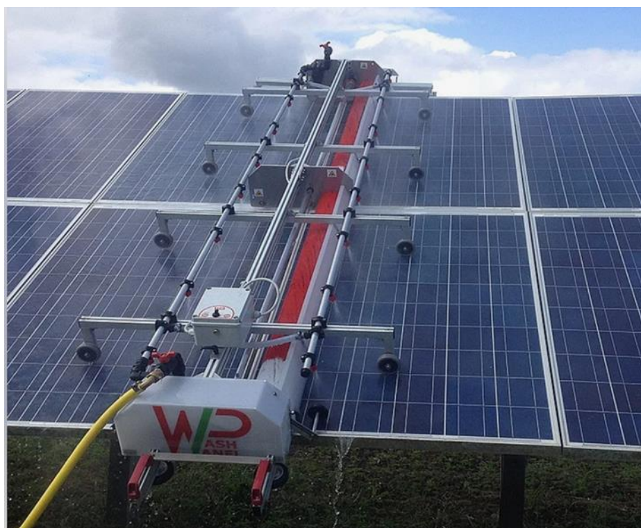
Рисунок 1 – Автоматическая щёточная система очистки солнечных панелей
