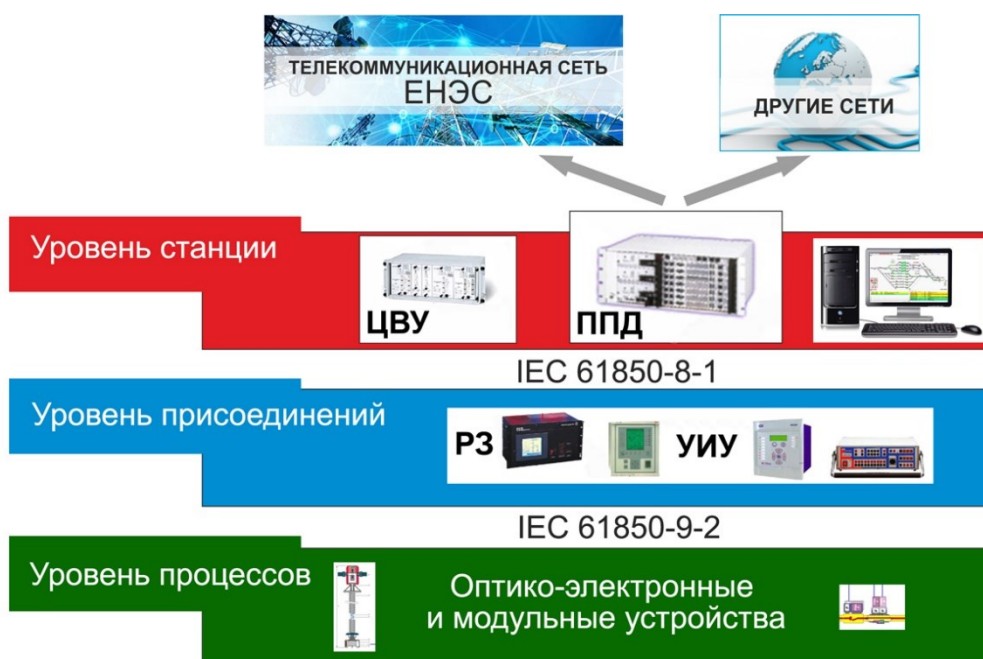
Рисунок 1 - Структура АСУ ТП ЦПС 110/35 кВ
